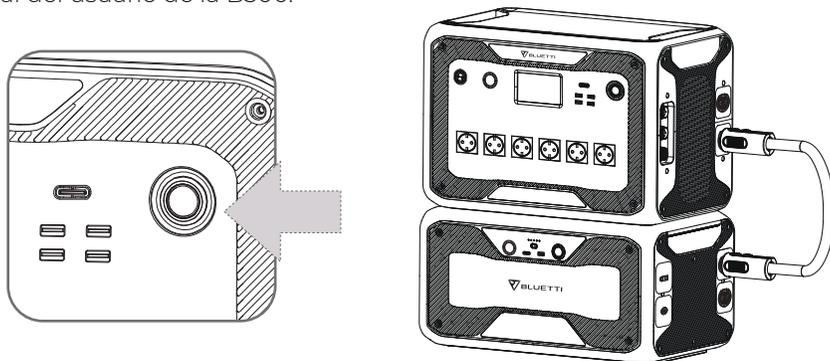
**Nota:** Conecte el AC300 y el B300 con el cable de expansión de la batería.
